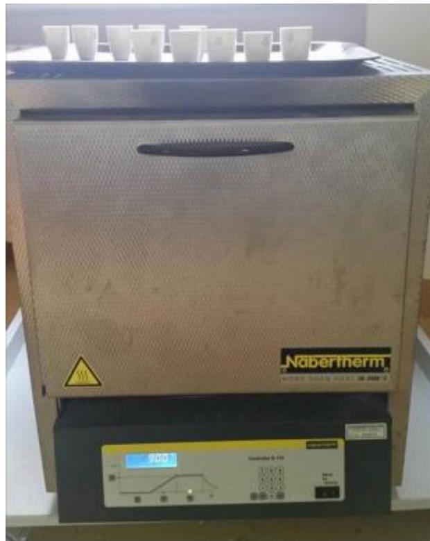
Slika 4.2. Prikaz mufolne peći
