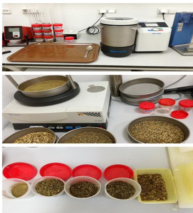
Slika 3.2.1.1. Laboratorijski mlin, postupak prosijavanja i usitnjeni uzorci (Izvor: vlastiti izvor)
