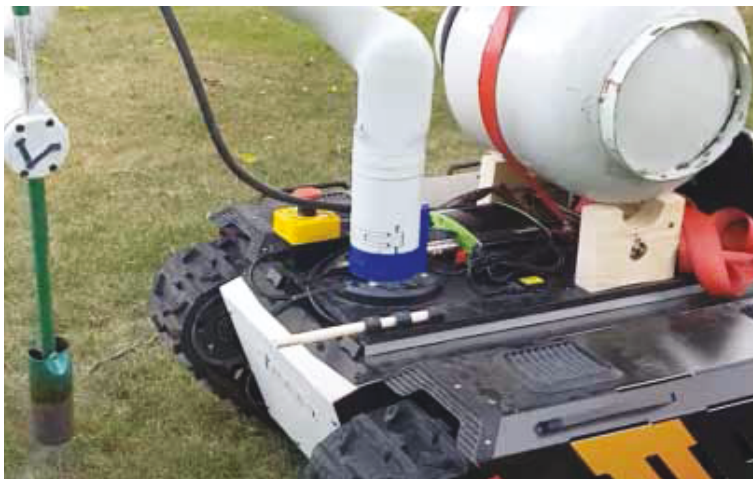
Slika 7. Robot za suzbijanje korova plamenom Ultimate Weed Killing Robot
