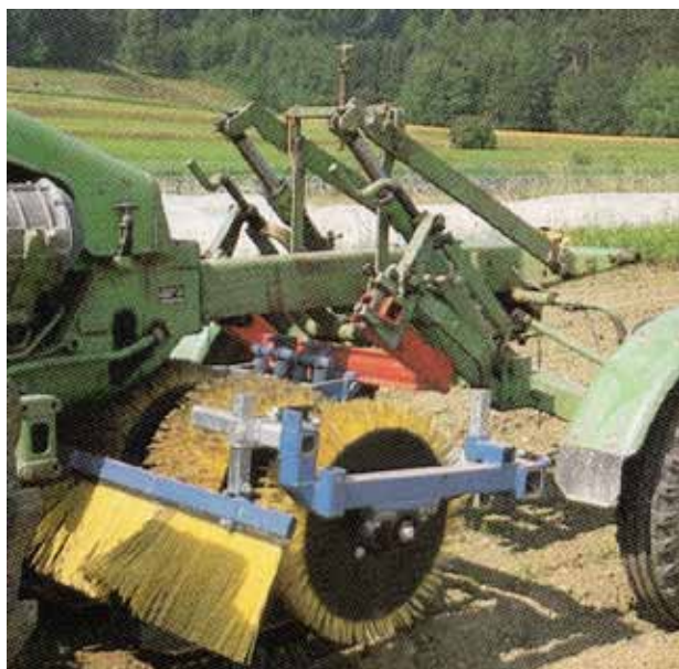
Slika 8. Četkasti kultivator (Izvor: Dierauer i Zimmer, 1994) Picture 8. Brush cultivator (Source: Dierauer i Zimmer, 1994)
