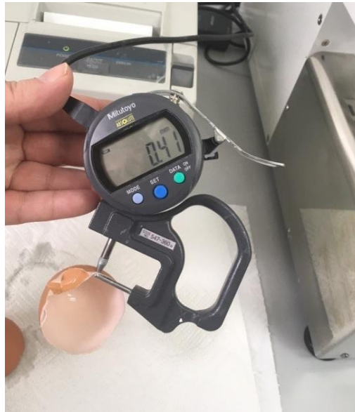
Slika 26. Digital Egg Tester DET 6000, mjerenje debljine ljuske (Izvor: D. Bedeković)
