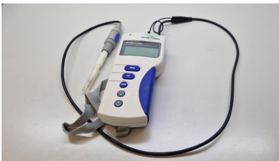
Slika 20. Digitalni pH-metar Mettler MP120-B (Izvor: Z. Kralik)
