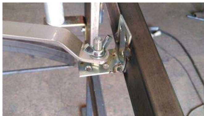
Slika 47. Leptir matica sigurnosnog sustava odvajanja poluge
