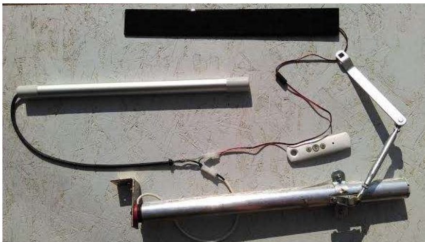
Slika 42. Elementi sustava daljinskog upravljanja vratima traktora
