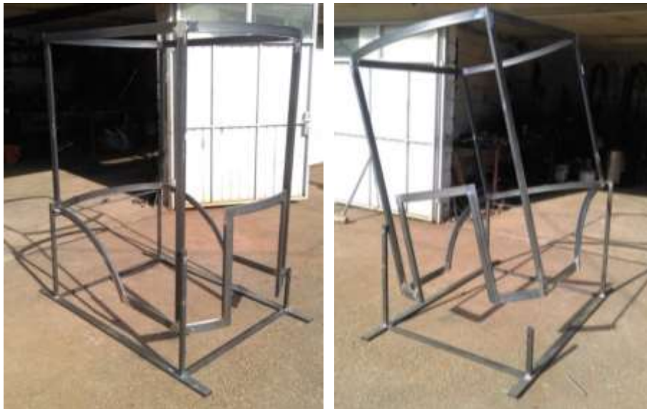
Slika 41. Model traktorske kabine u neutralnom položaju i u položaju nagiba od 15^\circ
