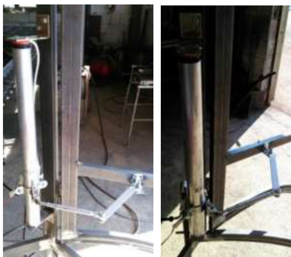
Slika 50. Montaža sustava na okvir i vrata kabine
