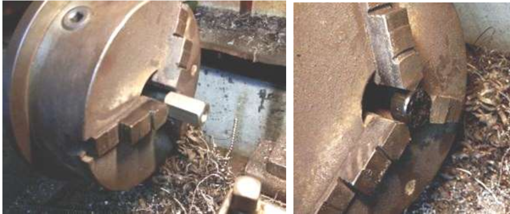
Slika 58. Tokarenje matice i plastičnih prstenova
