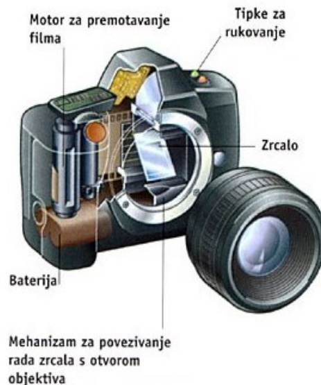
Slika 3. Dijelovi analognog fotoaparata (Izvor: http://www.mrdjenovic.com teme/obiljezja-savremenih-fotoaparata/ )
