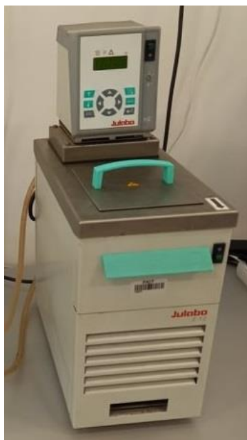
Slika 21. Julabo E 12 termostat korišten u FC-e metodi
