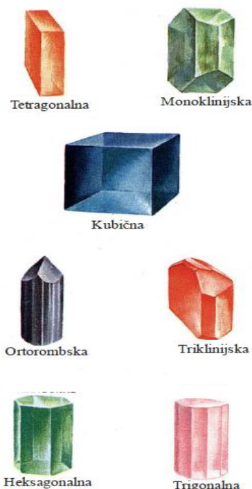
Slika 7. Vrste osnovnih kristalnih rešetki [4]
