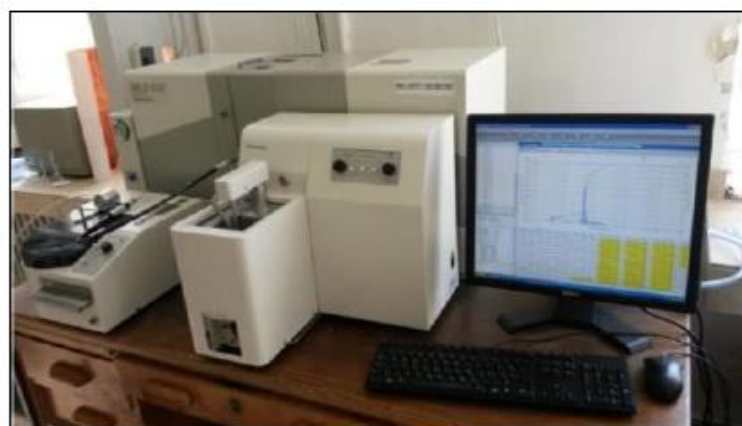
Slika 20. Uređaj Shimadzu Sald 3101 za određivanje RVK
