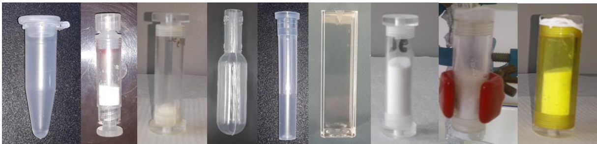
Slika 54. Korištene kolone u radu: eppendorf kiveta, Supelco kolona, kolona s tankom stijenkom (0,5 mm), plastična pipeta, kanila od igle, kiveta DLS, polikarbonatna kolona PC (debljina stijenke 1 mm), PC (debljina stijenke 2 mm). Slika je povezana sa Tablicom 13 .
