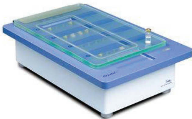
Slika 5. Prikaz uređaja Crystal 16 . 19
