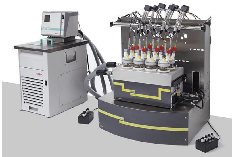
Slika 6. Prikaz uređaja CrystalSCAN . 20
