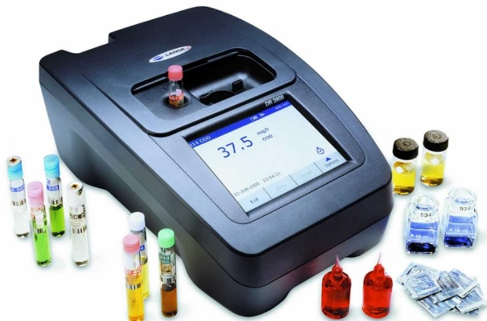
*Slika 10.* DRB2800 spektrofotometar, Hach
