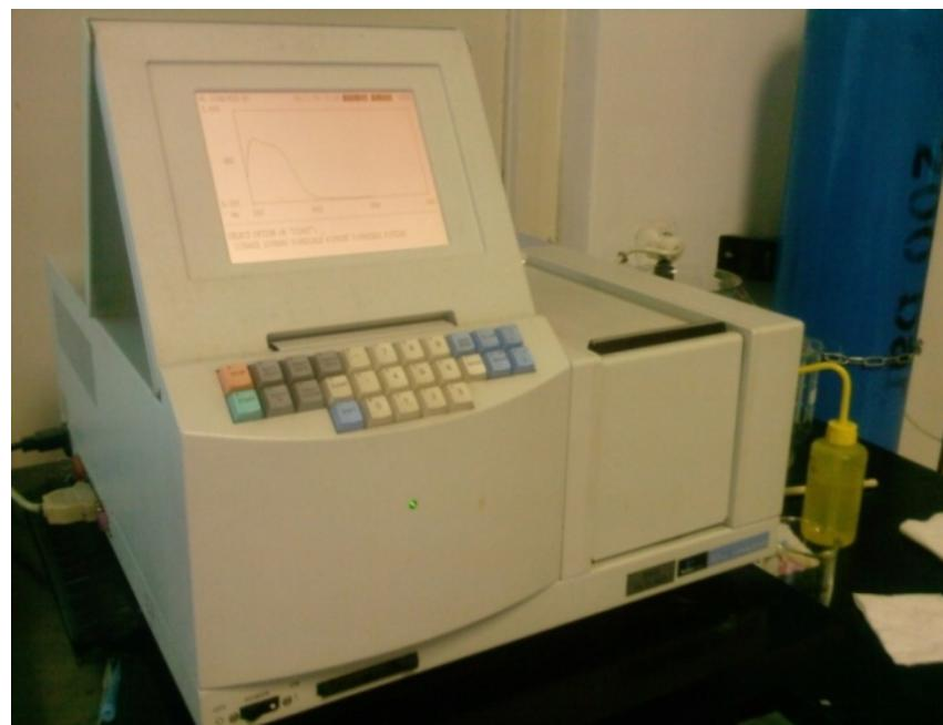
*Slika 7.* UV/VIS spektrofotometar, Lambda EZ 201, Perkin Elmer
