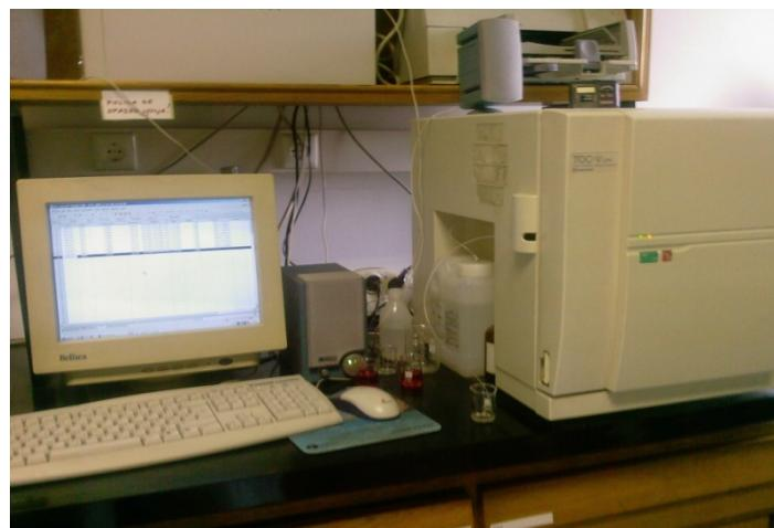
Slika 6. TOC analizator, TOC-V<sub>CPN</sub>, Shimadzu
