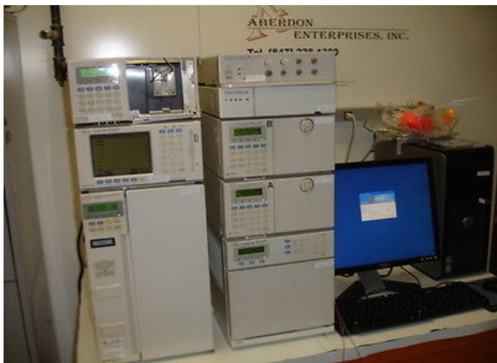
*Slika 9.* Tekućinski kromatograf visoke djelotvornosti, Shimadzu
