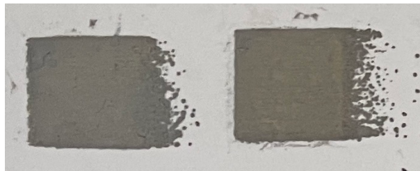
Slika 4.10. Ispis Dycotec tinte na komercijalnu PET podlogu u tri (lijevo) i četiri slojeva (desno).
