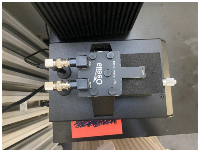
Slika 7. Sonda za mjerenje površinskog otpora u 4 točke (eng. four-point probe ).
