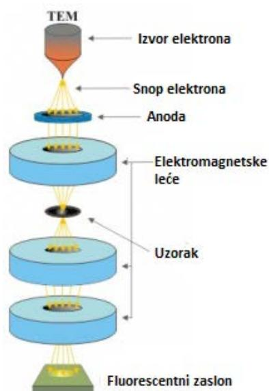
Slika 7. Transmisijski elektronski mikroskop
