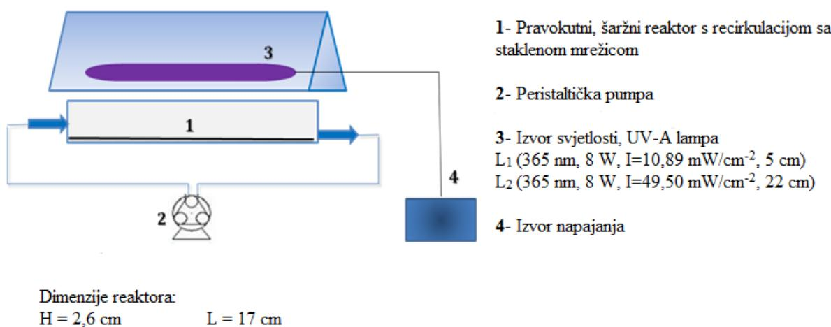
**Slika 13.** Shema fotoreaktorskog sustava
