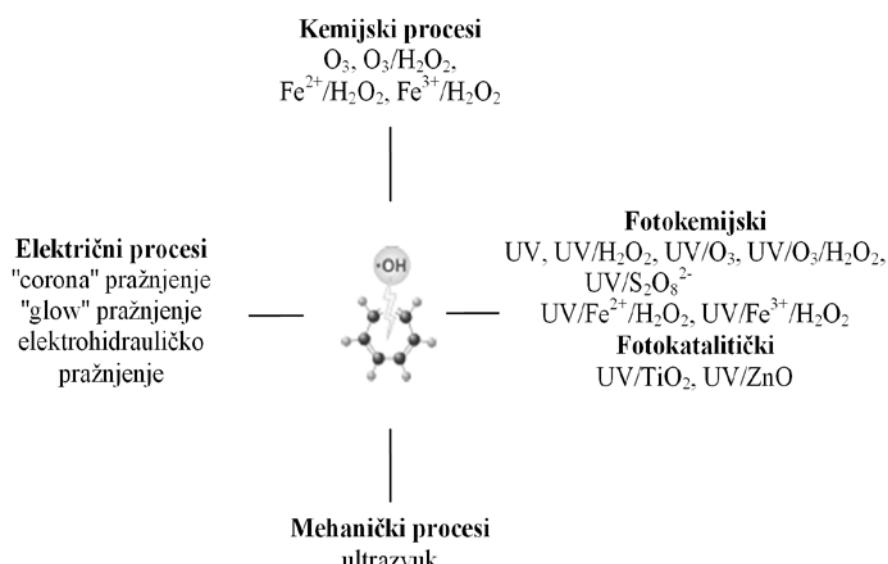
**Slika 1.** Shematski prikaz naprednih oksidacijskih procesa i njegovih kombinacija
