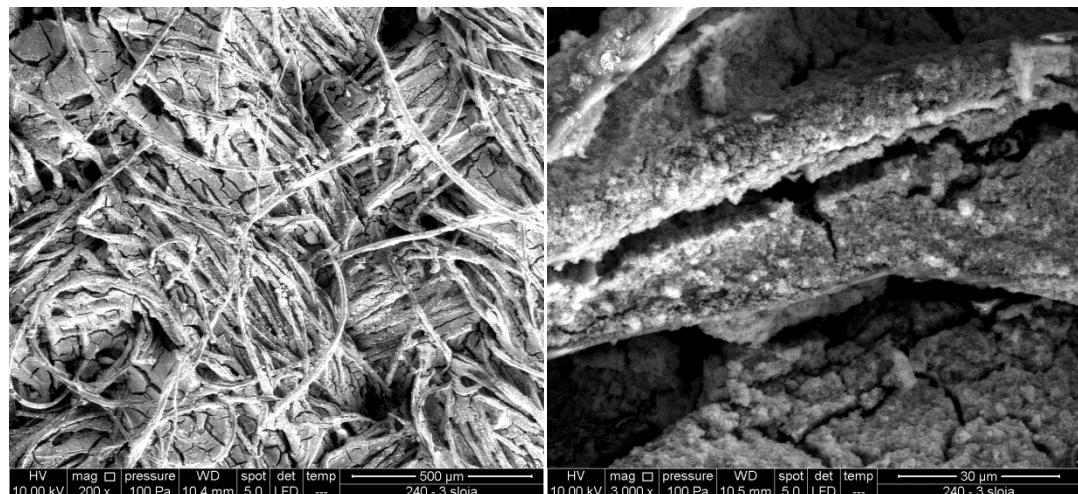
**Slika 17.** SEM snimka pamuka ( $\rho=240 \text{ g/m}^2$ ) s  $\text{TiO}_2$  uvećana 200 i 3000 x
