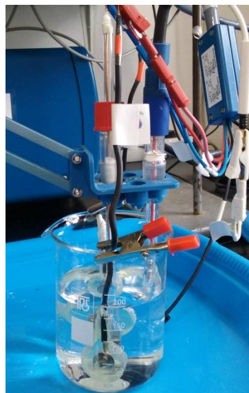
Slika 3.4. Troelektrodni sustav za elektrokemijska mjerenja
