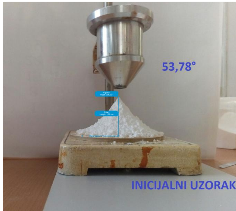
Slika 3.9. Fotografija prikaza mjerenja kuta mirovanja inicijalne laktoze monohidrata.
