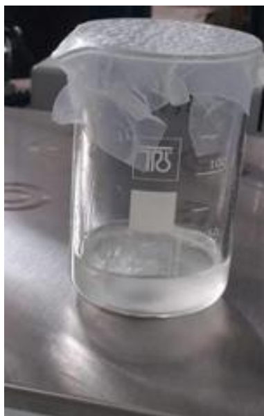
Slika 22. Otapanje NaOH u metanolu
