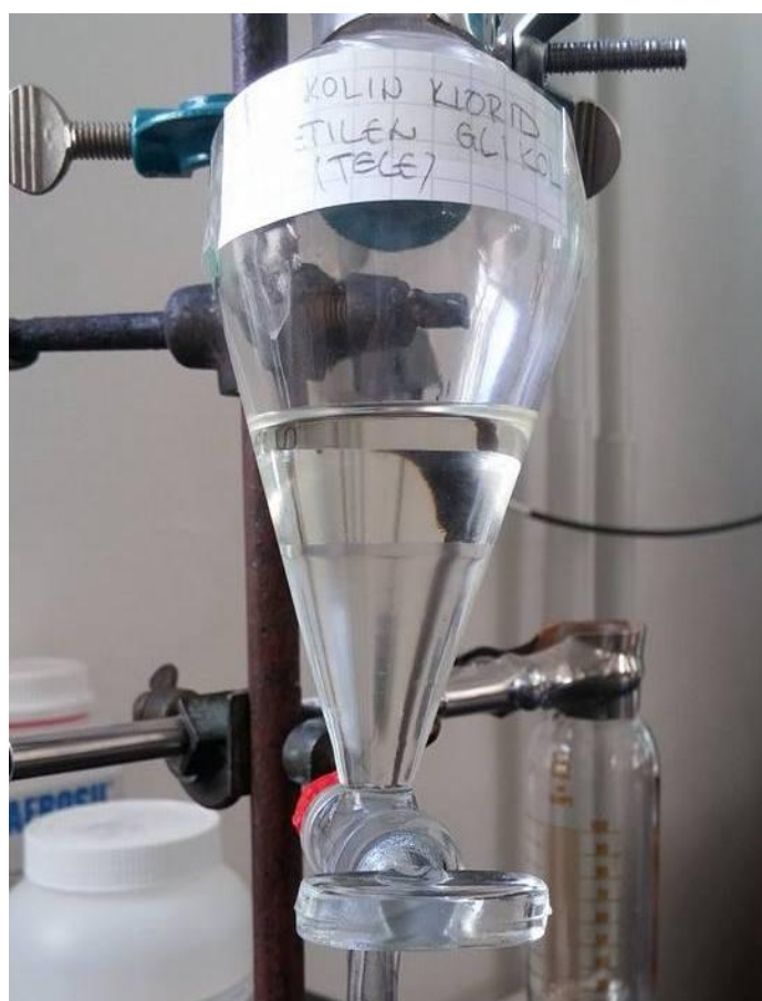
Slika 28. Separacija biodizela i eutektičkog otapala
