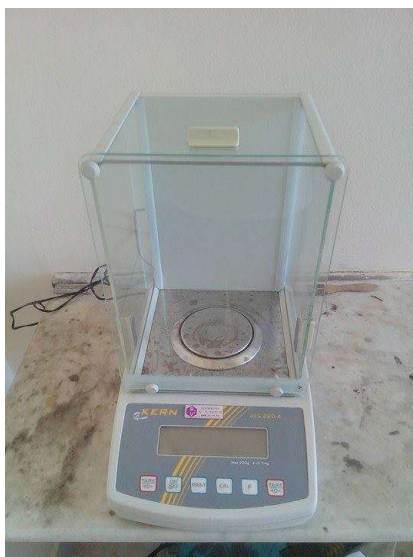
Slika 10. Analitička vaga ALS 220-4, Kern
