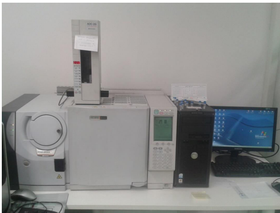
Slika 6. Vezni sustav plinski kromatograf-spektrometar masa GCMS-QP2010 Plus, Shimadzu
