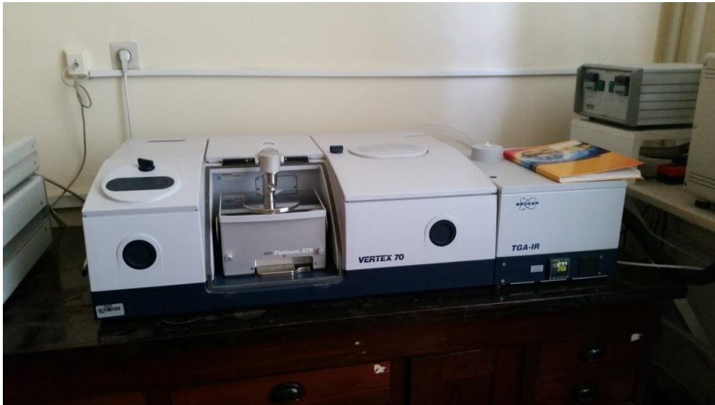
Slika 27. FTIR spektrometar Bruker Vertex 70
