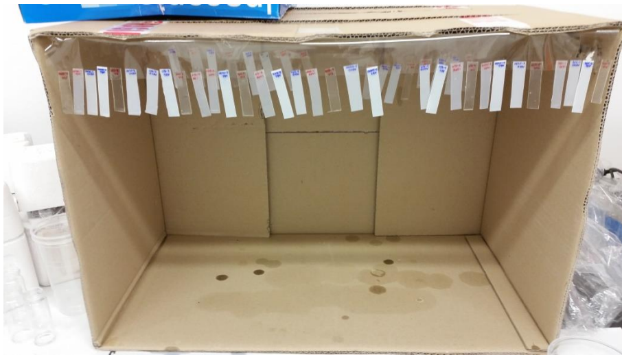
Slika 24. Viseći uzorci polimera prilikom sušenja na sobnoj temperaturi
