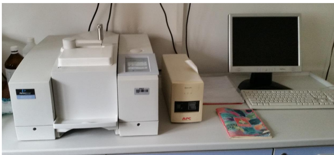
Slika 28. FTIR spektrometar PerkinElmer Spectrum One
