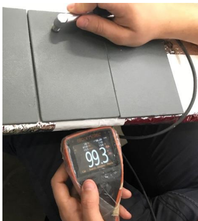
Slika 28. Određivanje DSF pomoću uređaja Elcometar 456
