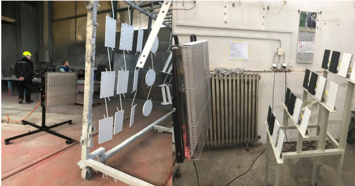
Slika 10 Primjena IC zračenja za sušenje premaza
