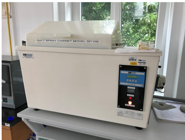
Slika 30. Slana komora SF/100 na Zavodu za elektrokemiju
