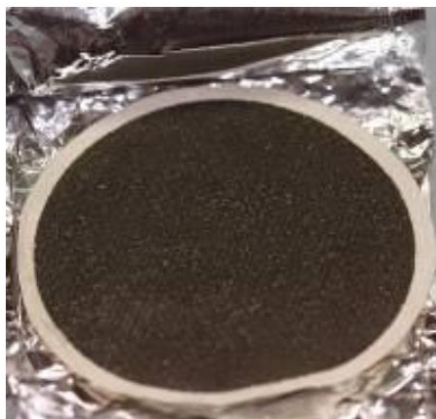
Slika 25. Uzorak frakcije lebdećih čestica PM 1 sakupljen na kvarcnom filtru
