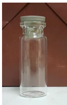
Slika 3.1. Kotlasti reaktor V = 5\text{ cm}^3
