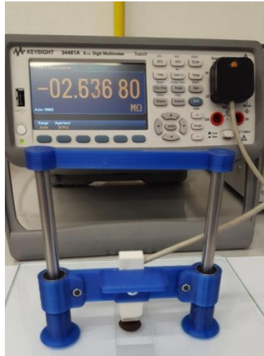
Slika 3.7 Uređaj i sonda za mjerenje električnog otpora.
