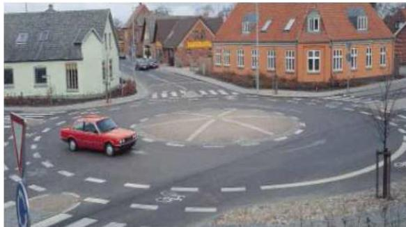
**Slika 24. Vođenje biciklista unutar kružnog raskrižja**
