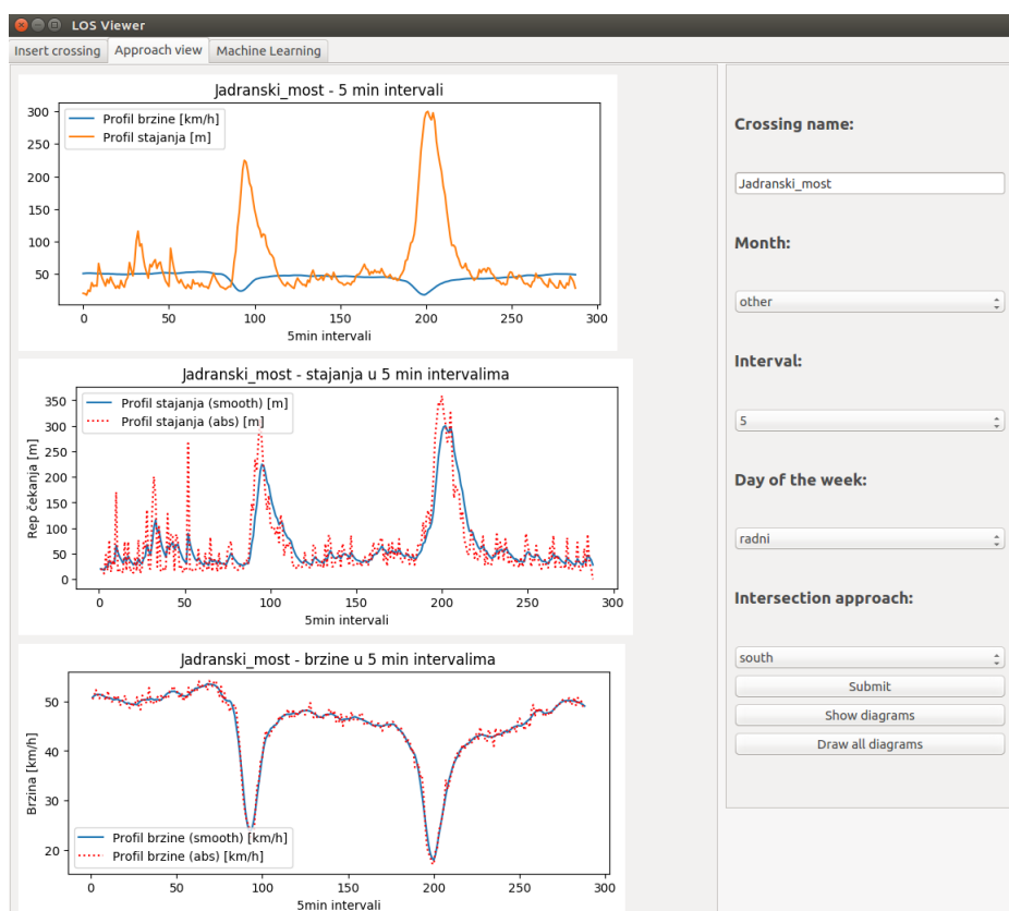
Slika 5.7: GUI - prikaz repova čekanja i profila brzina
