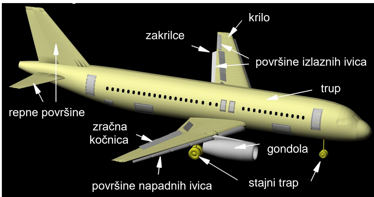
Slika 4. Općeniti prikaz izvora aerodinamičke buke, [6]
