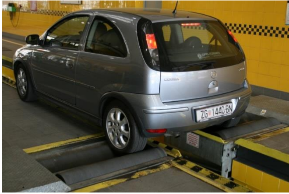
Slika 26. Vozila na valjcima za ispitivanje kočne sile
