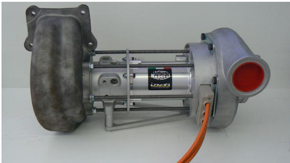
Slika 23. Spoj motor-generatora toplinskog (MGU-H) i turbopunjača
