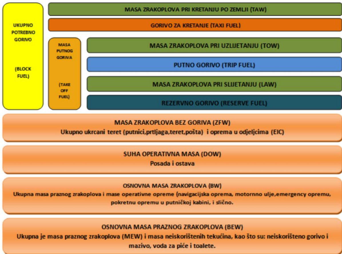
Slika 5. Mase zrakoplova i njihov međusobni odnos Izvor: [11]
