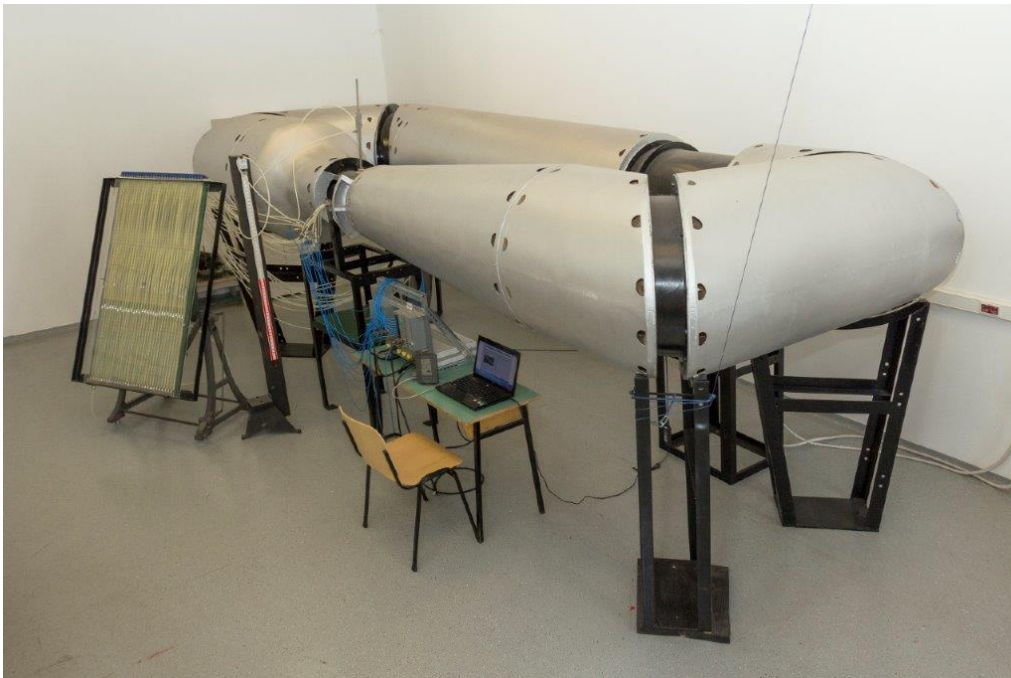
Slika 25: AT-1 zračni tunel [9]
