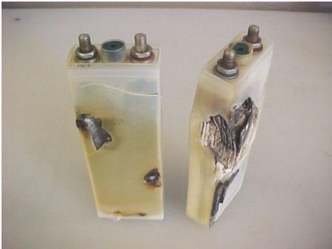
Slika 3: Oštećenje nikal-kadmij ćelija uzrokovano toplinskim bijegom, izvor: http://www.rcgroups.com/forums/showthread.php?t=2180331&page=874
