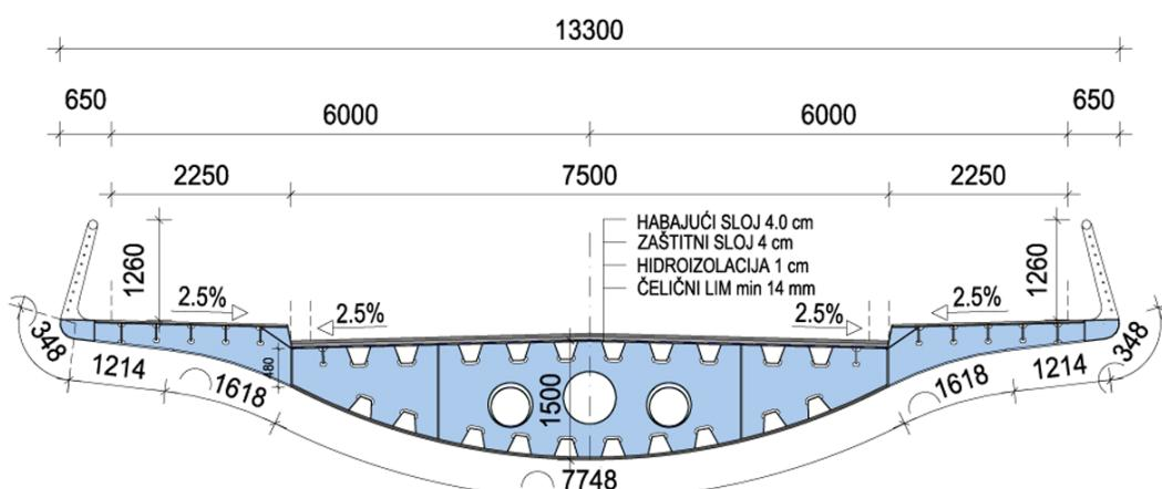
**Slika 11.** Poprečni presjek rasponskog sklopa
