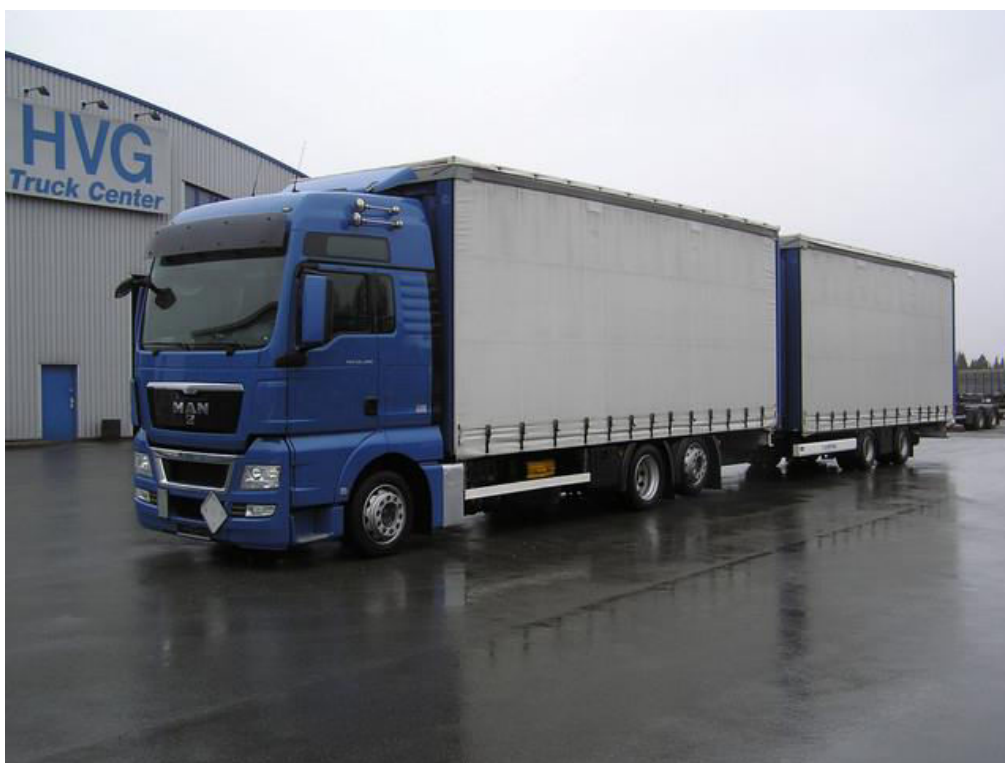
Slika 6. Kamion s tri osovine i prikolica s dvije osovine
