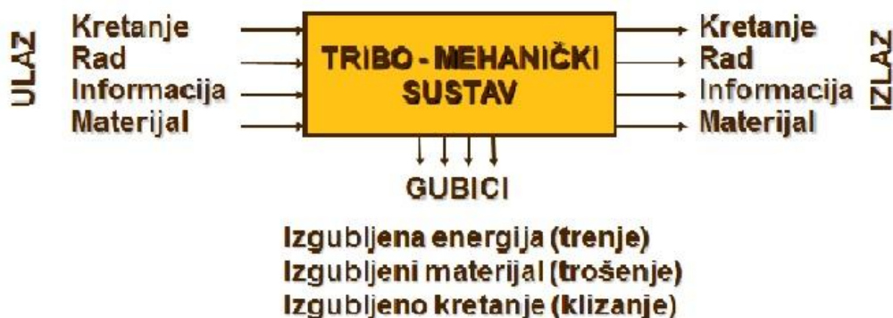
Slika 3.4. Shema tribomehaničkog sustava, [4]
