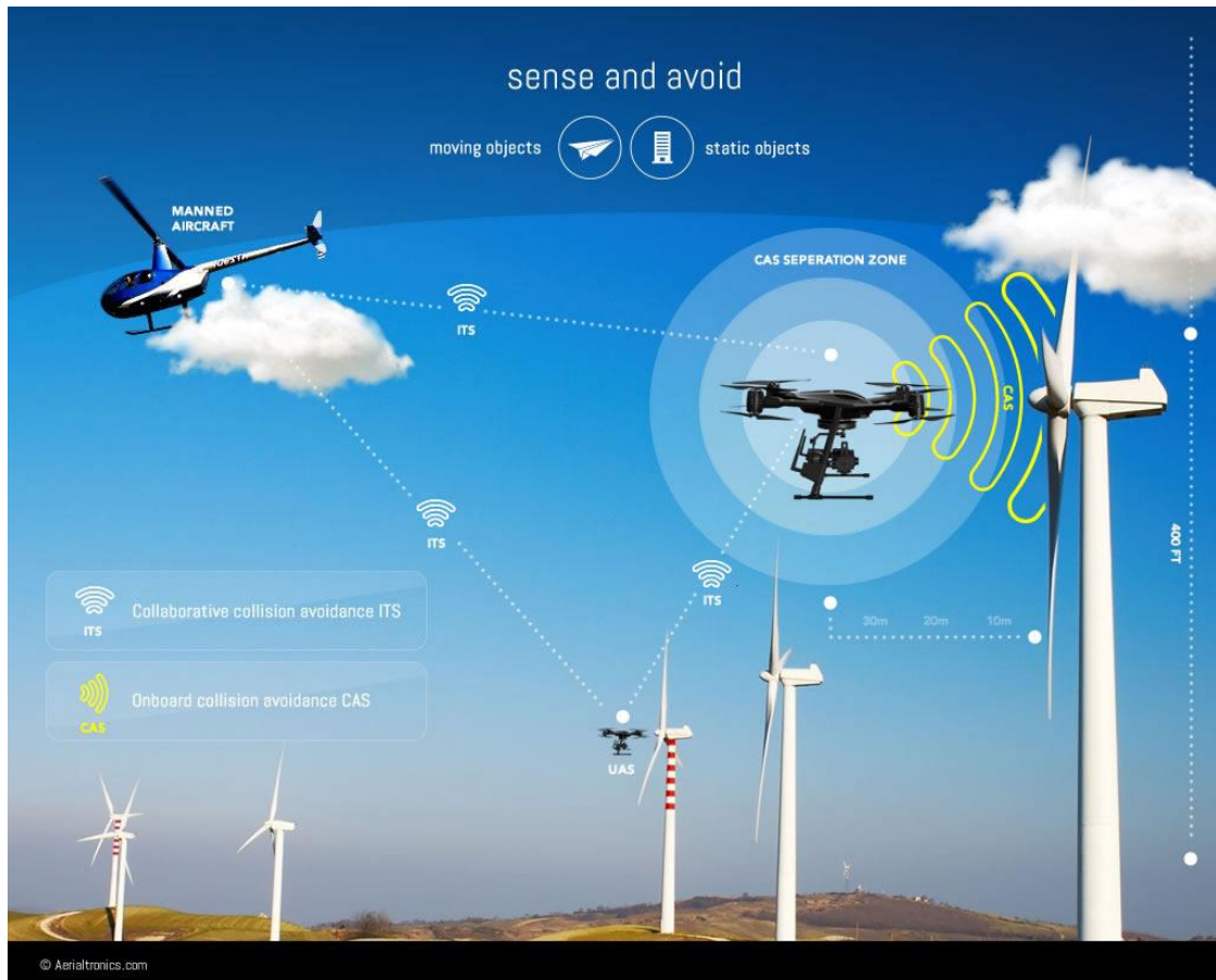
Slika 13. Princip rada „Osjeti i izbjegni“ sustava, [25]
