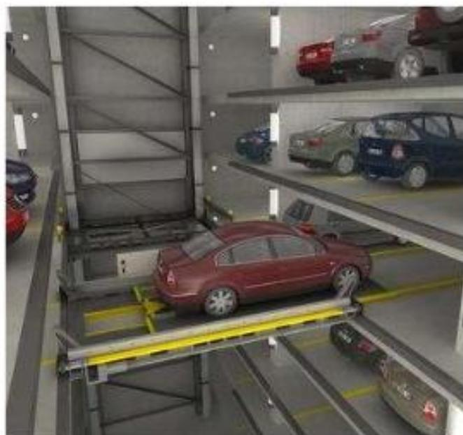
Slika 11.: Pomična platforma po horizontalnoj i vertikalnoj osi; [10] [www.koch.hr](http://www.koch.hr)
