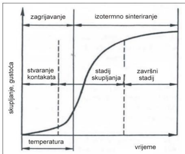
Slika 4. Stadiji sinteriranja u čvrstoj fazi [1]
