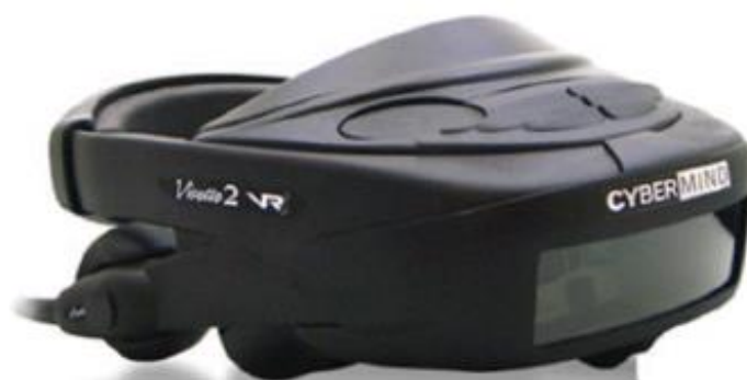
Slika 12. Naglavni zaslon (HMD, eng. Head Mounted Display ) [14]
