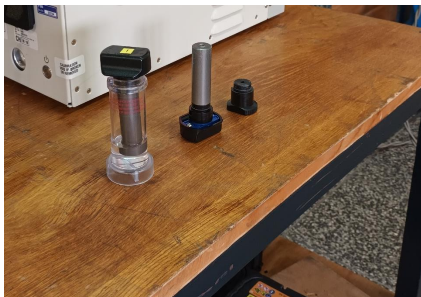
Slika 4.1. Natapanje umetka izopropilenom
