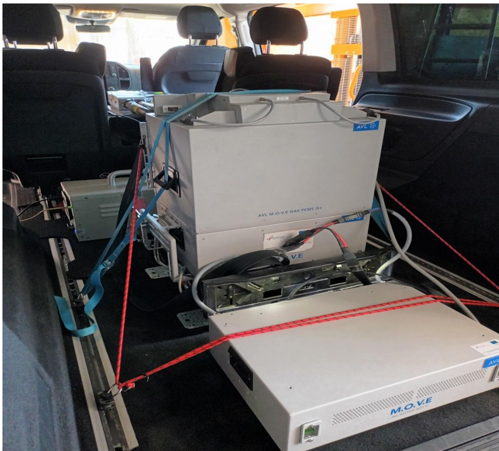
Slika 5.2. Uređaji za mjerenje montirani u vozilo
