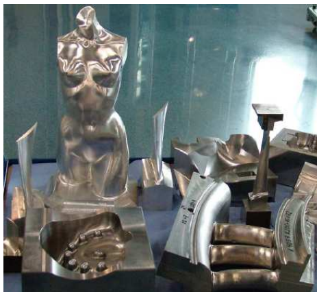
Slika 3.9. Oblici izradaka dobiveni glodanjem [2]
