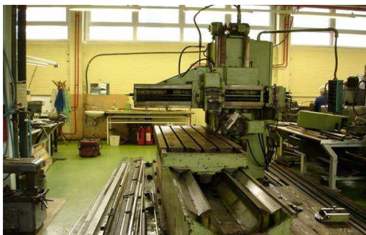
Slika 4.2. Blanjalica u postojećem stanju i prije rekonstrukcije
