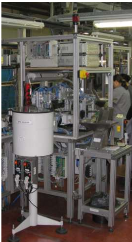
Slika 5. Automat za montažu čahure, opruge i ležaja
