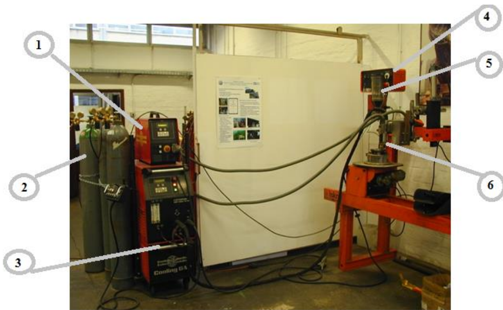
Slika 22 Oprema za plazma navarivanje praškom [18]
