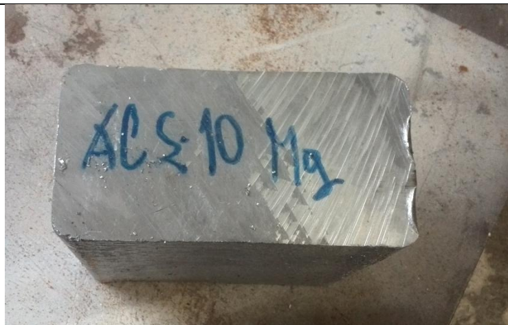
Slika 63. Ingot od legure AlSi10Mg
