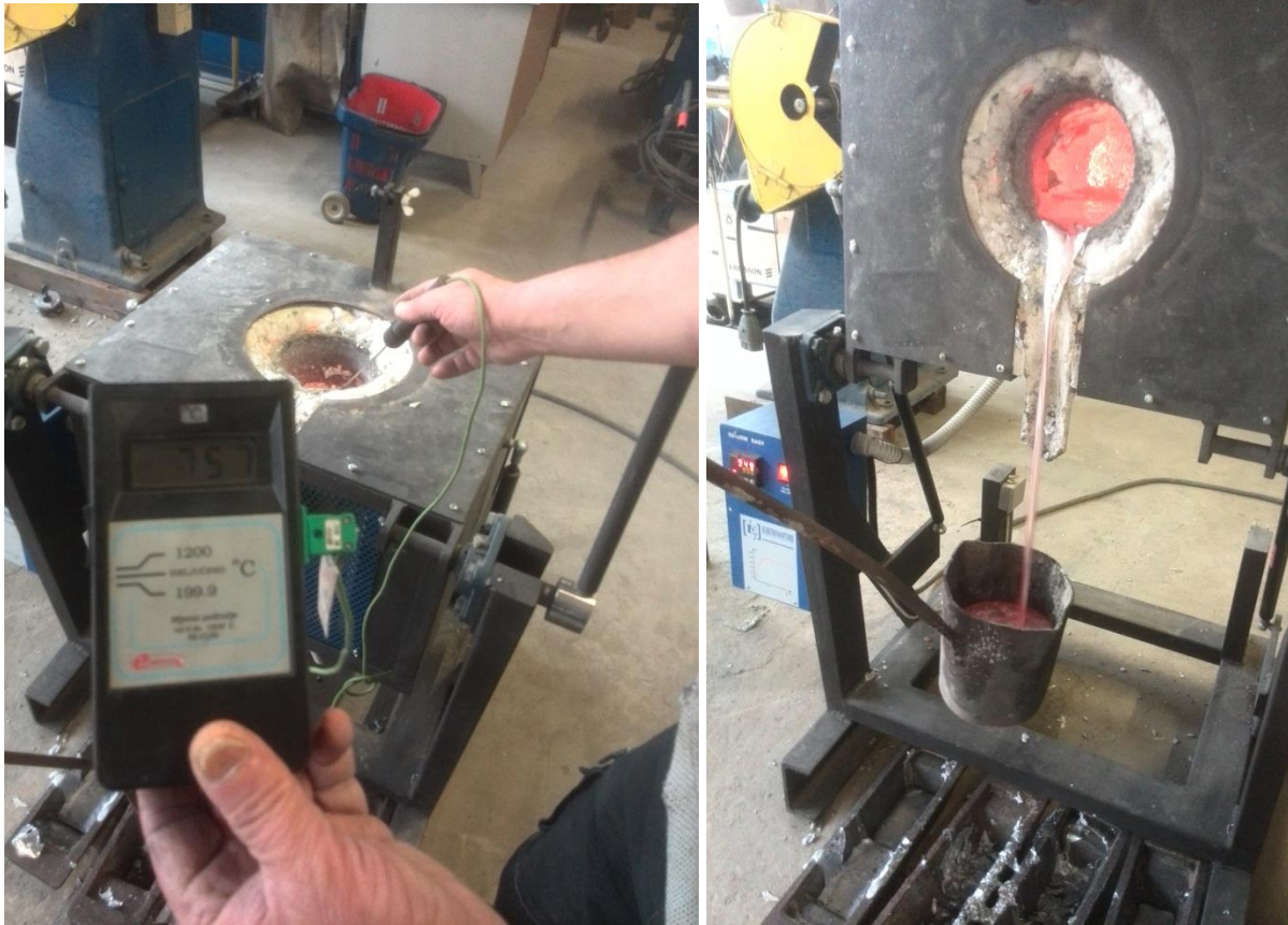
Slika 66. Mjerenje temperature taljevine i lijevanje u zagrijani lonac
