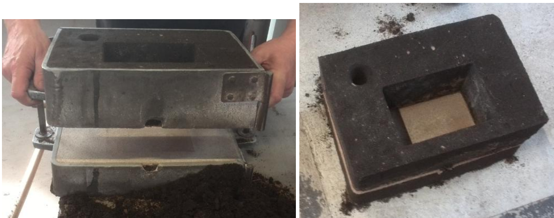
Slika 61. Sklapanje gornjeg i donjeg dijela kalupa
