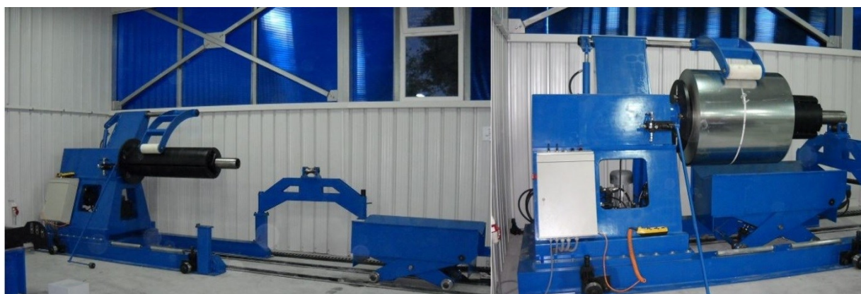
Slika. 23. Odmatalica lima s kolicima [13.]
