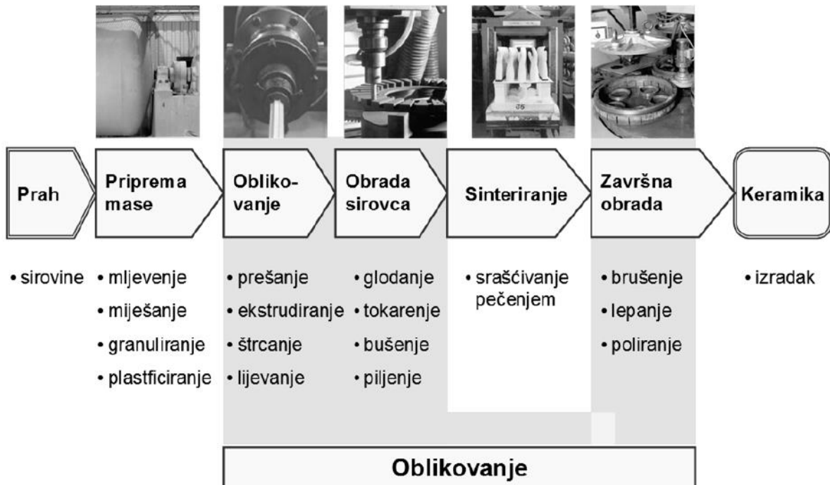
Slika 5. Shema postupka proizvodnje keramičkih izradaka [5]
