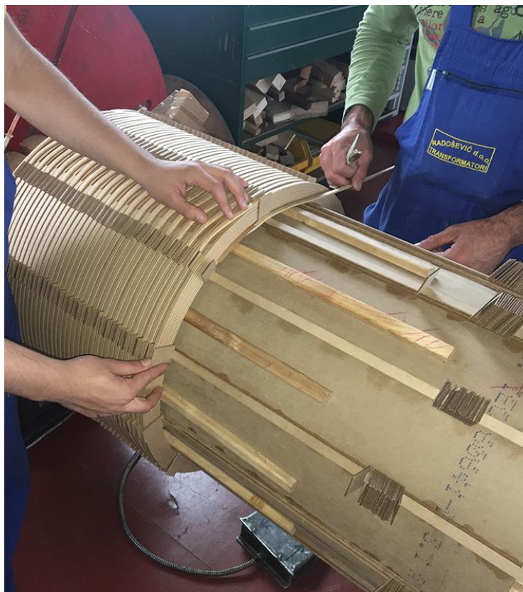
Slika 11. Izrada izolacije od papira
