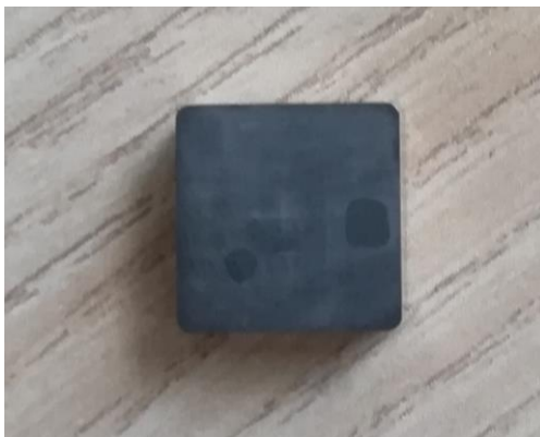
Slika 36. Rezna pločica SNUN 120408
