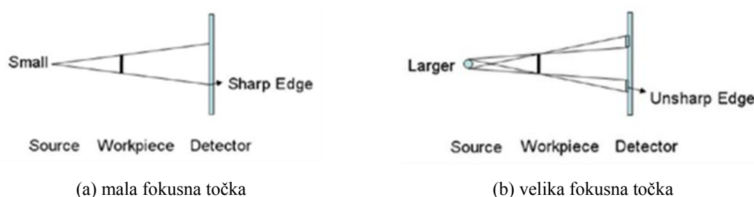
Slika 13. Efekt fokusne točke [1].
